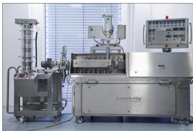
**Figure 4:** The leistriz twin screw extruder
